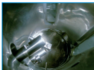
Wirbelkammer mit Bottom-Spray-Düse und 2 Sonden IPP 50-S in verschiedenen Einbaupositionen
