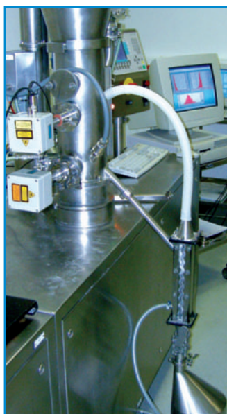
In-line-Messsonde IPP 50-S an 2 Einbaupositionen unterschiedlicher Höhe an einem Granulierer vom Typ AGT 150
