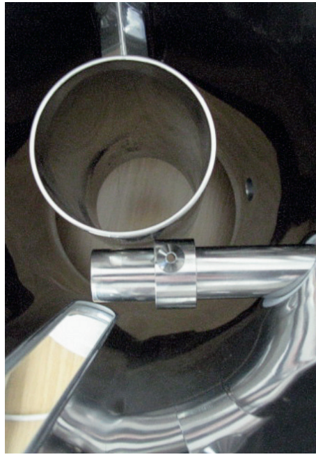
Bild 6: Tangentialer Einbau der Messsonde IPP 70-S mit Inline-Dispergierer
