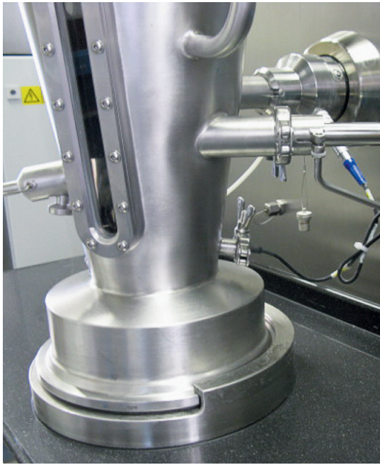
Bild 1: Messsonde IPP 70-S, im Betrieb in der Wirbelschichtanlage GPCG 2
