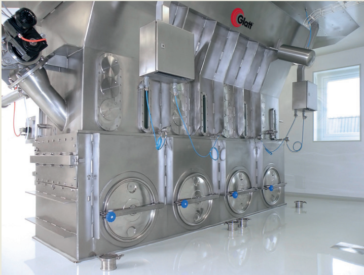
DIE PROZESSKAMMER DES GFG 250 ist etwa 3,5 m lang, 0,8 m breit und 0,7 m hoch. Das Hold-up beträgt je nach Produkt und Verfahren zwischen 200 und 700 kg. Bild: IPC Process-Center
